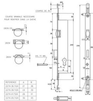
Verrouillage en 2 tours de clé. Mécanisme à engrenages.
