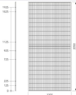
Le ST20 est un panneau de protection de machine léger avec un cadre de 19 x 19 mm. Tous les éléments de grillage horizontaux sont soudés au cadre et les éléments verticaux sont soudés aux tubes de traverse afin d'obtenir un panneau stable et résistant aux chocs.
