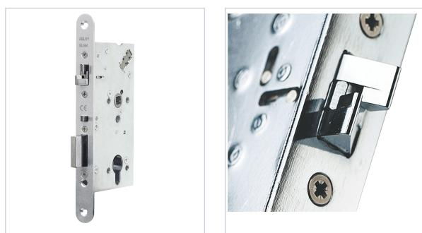
Contact de position : pêne rentré/sorti, pêne pilote actionné/non actionné, actionnement de la bâquille et du cylindre. Boucle anti-sabotage, convient pour les portes coupe feu, adaptation automatique de la tension, tolérance tension -10 + 15 %.
