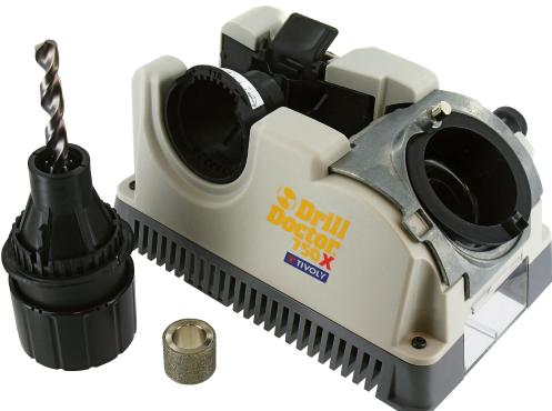
Machine compacte et portable. Usage facile et rapide. Permet en plus l'affûtage des forets béton à pastille carbure. Permet de réaffûter en quelques secondes les forets métaux HSS, HSS Cobalt, revêtu, affûtage dépouille conique et pointe en croix.
